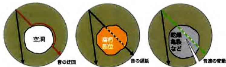
図9.2-5 立木の音響を用いた非破壊検査の原理(樹幹横断面)
