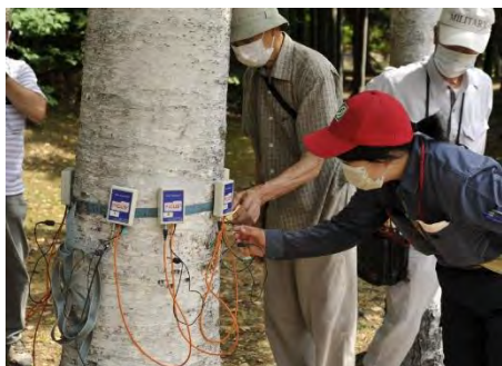
写真-1 釘・モジュール取り付け
