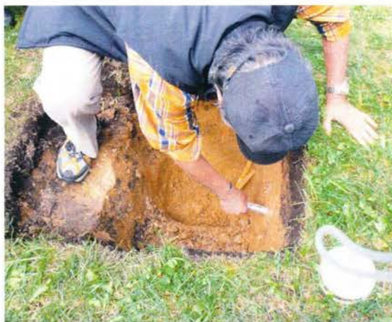
土壌硬度計で土層の硬さを測る
